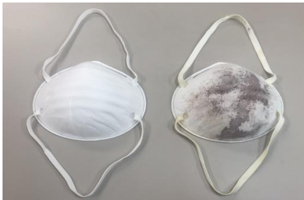
図3 無処理マスク（左）、捕捉された暗紫色セシウム含有結晶を形成した白金ナノ粒子担持マスク（右）
