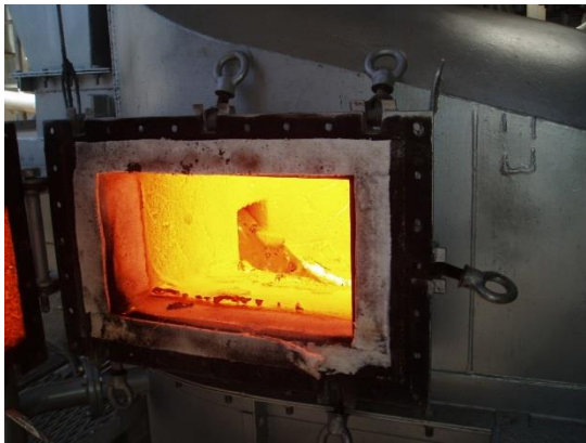
写真 4 焼却残渣熔融試験（模擬廃棄物）
