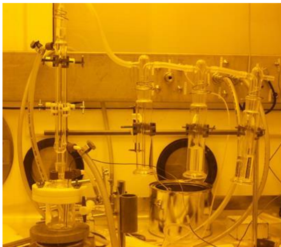
図 4 化学的ホットセル内に配置された溶解装置の例
