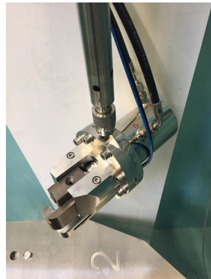
図3 制御棒を切断するための工具
