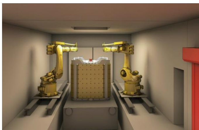
図3 標準輸送容器の「ボルト外し」と「ボルト締め」工程 1)
