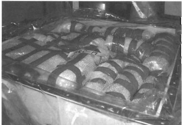
そこで、二次廃棄物の発生量の低減及び解体廃棄物の処理等の労力を軽減することを目的に、廃棄物を養生無しで直接容器に収納でき、容易に取り出せ、かつ繰り返し使用できるシステム（以下、「廃棄物直接収納システム」という）の開発を進めている。Fig.10に廃棄物直接収納システムの試験装置を示す。
