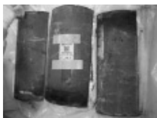
汚染の検出されていない試験片 50×50cm以下（半割配管）
